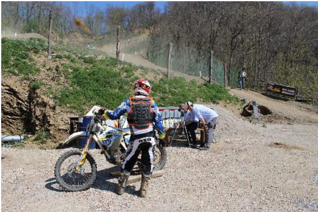
Figura 5.3.1 – Fase del rilievo fonometrico su moto da Enduro.
