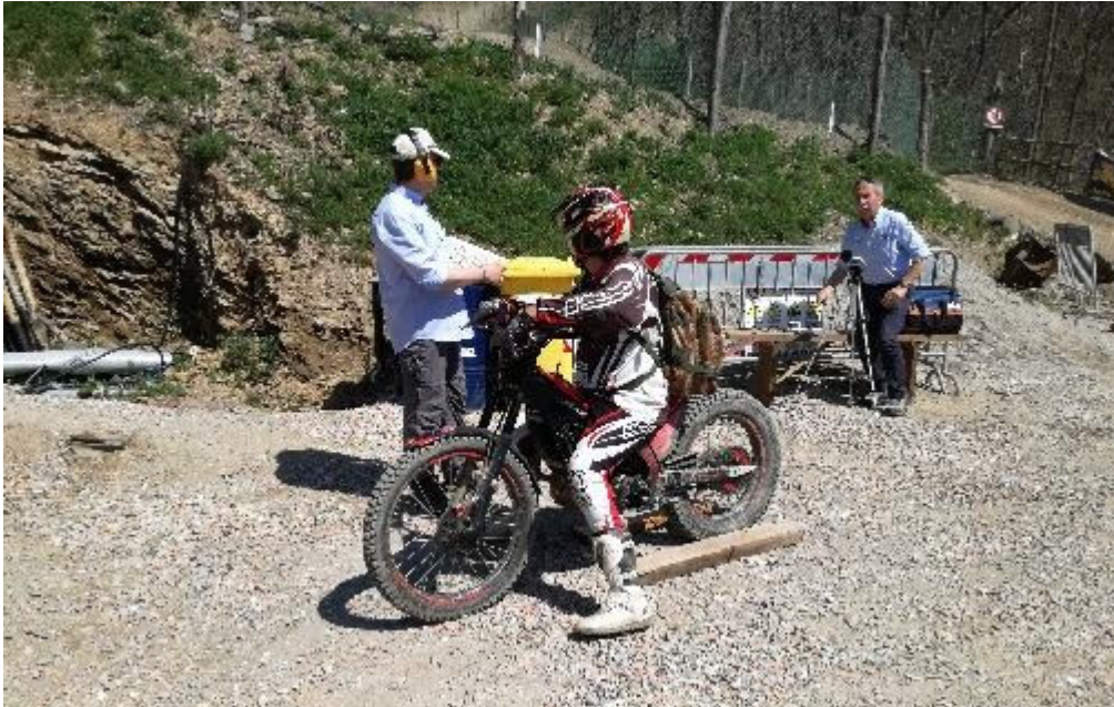
Figura 5.3.2 - Fase del rilievo fonometrico su moto da Trial.
